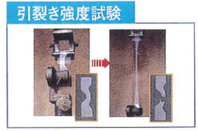
高引裂きシリコンシュートは分子を不規則に並べることで、シリコンの持つ優れた物性はそのままに、引裂き・引っぱりに対する強度を大幅にアップ。従来の汎用ゴムやキャンパスなどを使った場合よりも異物混入、交換作業によるライン停止回数減少します。生産効率の向上によるトータルコストの低減にぜひご活用ください。
